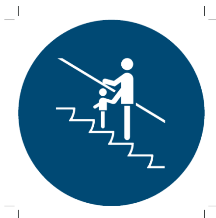
Figura G.1 – Señal de acción obligatoria "Los niños pequeños deben ir bien cogidos de la mano"
