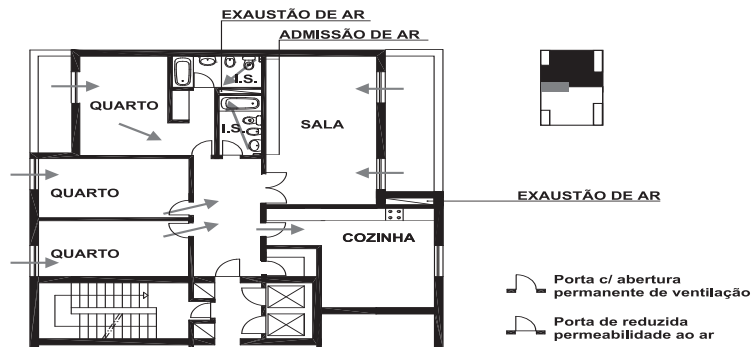
Figura 17 - Exemplo esquemático de sectores separados de ventilação numa habitação.
